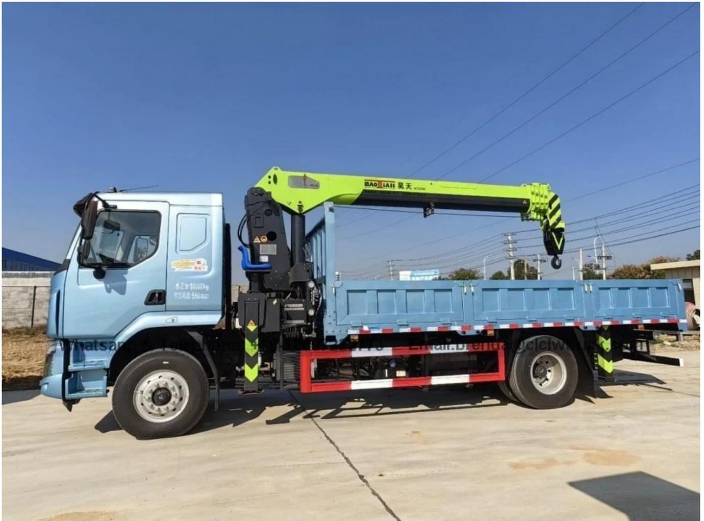
Brage de camion télescopique du bras droit: le bras de levage est une structure en forme de boîte à plusieurs coupes, qui peut être prolongée et rétractée comme une antenne. La plage de travail et la hauteur de levage sont principalement obtenues par extension et luffing. Il a un bon champ de vision et une grande hauteur de levage.
