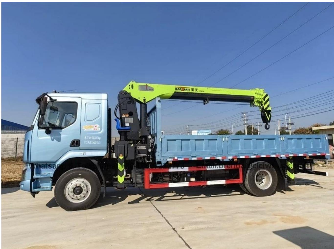
Guindaste de caminhão telescópico de braço reto: o braço de elevação é uma estrutura em forma de caixa de várias seções, que pode ser estendida e retraída como uma antena. O alcance de trabalho e a altura de elevação são alcançados principalmente por extensão e luffing. Tem um bom campo de visão e uma grande altura de elevação.
